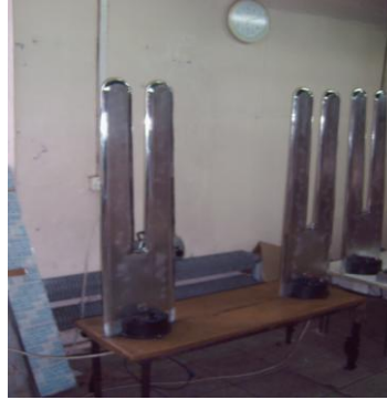
Rys.3. Elektryczne formy do stabilizacji termicznej. [2]
