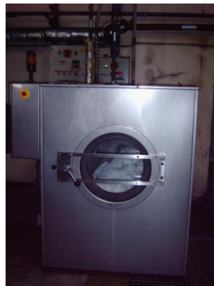
Rys.4 Maszyna rotacyjna typu „pralnica” [2]
