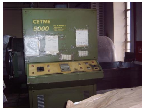
Rys. 5 Suszarka zasilana parą wodną. [2]
