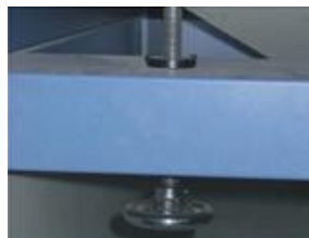
Rys.6 Mechanizm opuszczania i podnoszenia blatu.
